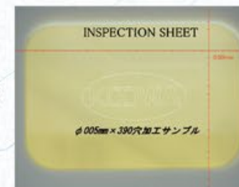
微細加工 ※1/100ミリのミクロン穴加工も可能です。
